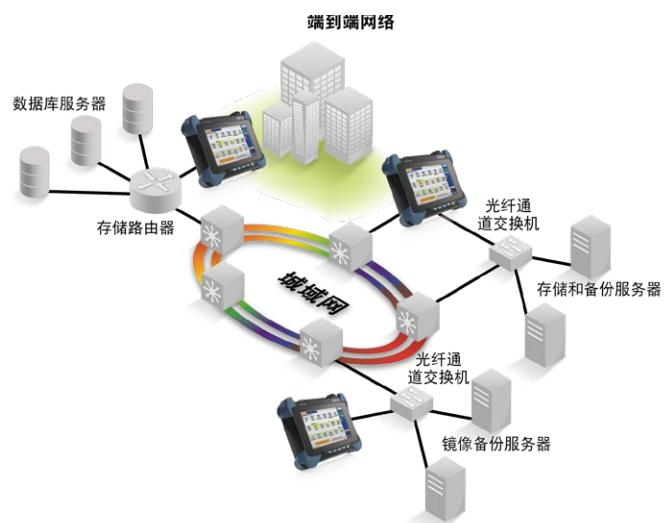
由于具备端到端测试功能，EXFO的FTB-700G V2系列可实现光纤通道网的快速部署和配置。可通过BER测试、延迟测量、缓冲区到缓冲区信用评估以及端口登录等功能来鉴定传输网、网络互联设备和末端节点间的通信。
