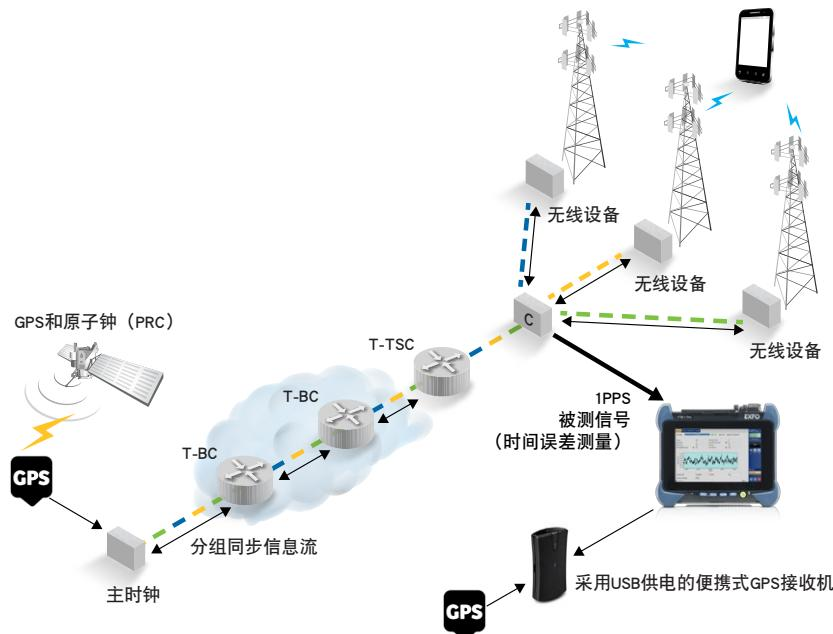
EXFO偏移应用提供MNO所需的所有测试结果，以便在开通或故障诊断期间，在蜂窝发射塔处评估参考信号/时钟的质量。偏移应用进行多个时间误差测量，如最大绝对时间误差（Max |TE|）、动态时间误差（dTE）、恒定时间误差（cTE）、最大时间间隔误差（MTIE）、时间偏差（TDEV）等。它能够自动评估被测信号是否满足不同的标准掩膜，如ITU G.8271.1、G8261、G.8282、G.811、G.812和G.813等标准规定的MTIE或TDEV掩膜。被评估的信号可能是1PPS、不同速率（如2 MHz等）的Ethernet-SyncE信号。会根据多个不同的标准向用户呈现判定结果。偏移应用还使用户能够放大最多三十天的时间误差图形化结果。同步专家可在测量时间误差的期间，轻松发现最重要的事件。
