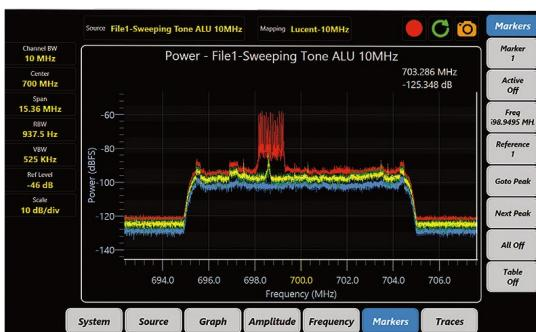
OpticalRF是一款易用的解决方案，可迅速发现外部RF干扰、内部PIM和外部PIM等问题。即使当BBU位于数千米以外更易于到达的地方时，如在集中型无线接入网（C-RAN）架构中，它也能够检测出RF干扰。
