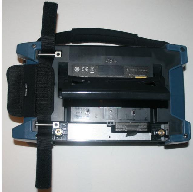
7. Usando uma chave Phillips (#1), gire os parafusos de retenção das hastes no sentido anti-horário até que elas se soltem.
