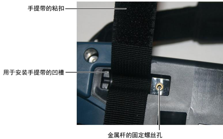
**12.** 用手指将手提带按入到凹槽内，同时用金属杆压住手提带，使螺丝孔朝上，且金属杆上的孔与设备上的孔对齐。
