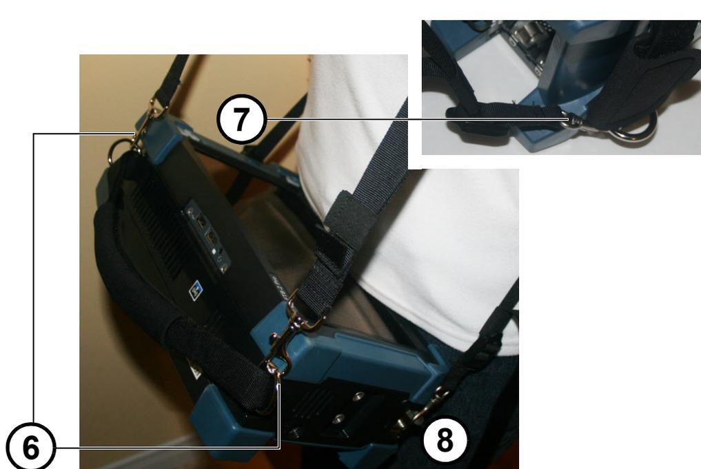
7. 将背带下半部分的弹簧钩挂在手提带的 D 形环上。
