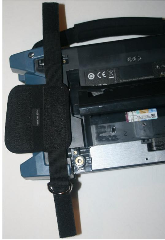
**11.** 将手提带按入到第一个凹槽内，这时仍要露出手提带的粘扣。
