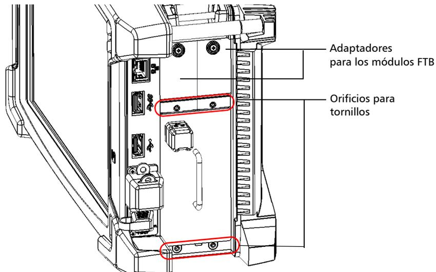
4. Gire el tornillo en el sentido de las agujas del reloj hasta que haga contacto con la placa frontal del módulo.
