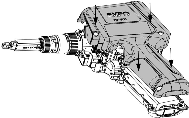
12. Con un destornillador hexagonal de 2,5 mm, gire los (6) tornillos en el sentido de las agujas del reloj hasta que se aprieten.
