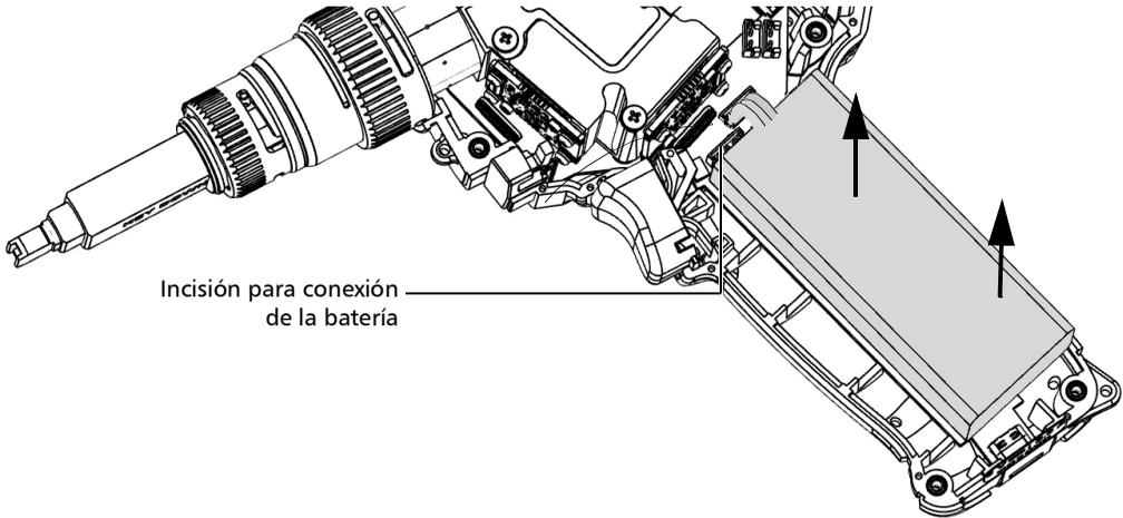
8. Coloque la nueva batería para que los cables y el conector queden en el mismo lado que la incisión de la carcasa de la unidad. El conector de la batería debe quedar apuntando hacia abajo.
