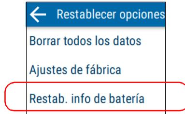
**13g.** Seleccione la entrada correspondiente al tipo de la nueva batería (indicada en la batería) y, a continuación, pulse **RESTABLECER**.
