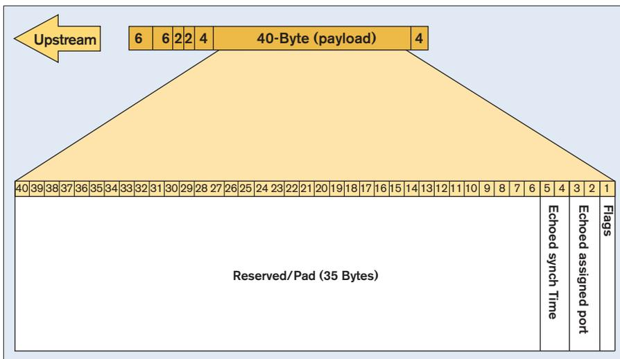
Figure 3.72 -- MPCP REGISTER\_ACK REPORT message payload
