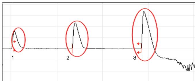
图4: (1)机械熔接、(2)法兰盘和(3)裂开的连接造成的菲涅尔反射
