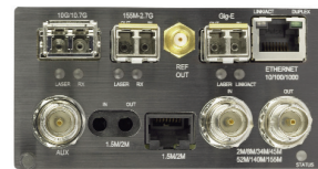
Das Modul FTB-8130NG mit Next-Gen SONET/SDH- und OTN-Hardware, einschließlich optischer und elektrischer Ethernet Add/Drop-Schnittstellen.
