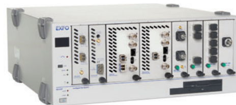
Le Module de test Ethernet Packet Blazer IQS-8510B peut être contenu dans le Système de test intelligent IQS-500, la puissante plateforme pour les applications de fabrication et de recherche d'EXFO.
