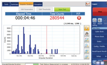
Abbildung 34. Eine Messung gezählter Impulsrauschenstöße vs. Impulsdauer
