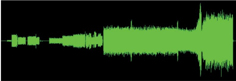
Abbildung 3. Spektrum der Kommunikationssequenz eines Einwahlmodems
