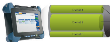
Alle SLA-Parameter (Durchsatz, Frame-Laufzeit, Frame-Verlust, Frame-Laufzeitschwankung, OOS, Pass/Fail-Ergebnis) werden für jeden Dienst gemessen.
