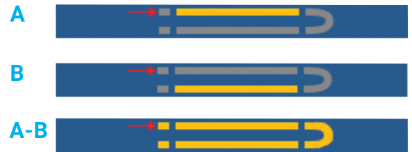
ループバックテスト方法とiOLMでiLOOPオプションを使用すると、2つのファイバーを同時にテストできます。表示されるのは、Aリンク、Bリンク、または完全A-Bリンク(ループを含む)のみです。
