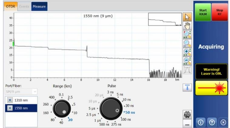
다이얼링 휠이 있어 즉석에서 실시간 인식 매개변수를 조정할 수 있으므로, 곧바로 트레이스에 나타나는 효과를 확인하여 최적의 효율성을 얻을 수 있습니다. 특성 분석을 시작할 준비가 다 됐다면? 수동으로 실시간 개입할 필요도, 메뉴에 액세스할 필요도 없이 "iOLM 시작" 버튼만 누르면 됩니다.
