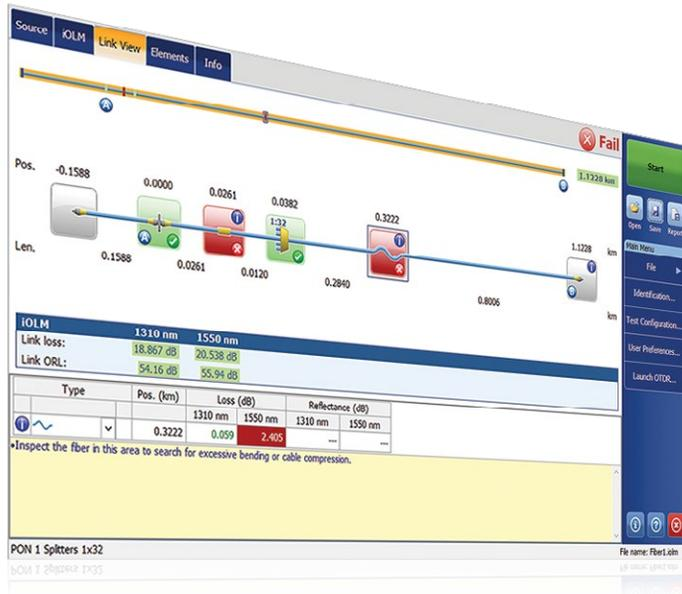
■ OTDR 테스트를 간소화하면서 동시에 모든 네트워크 토폴로지의 특성 분석 정확도를 최적화할 수 있습니다. iOLM은 상황에 따라 변용 가능한 지능형 알고리즘 기반입니다. iOLM은 아직 업계에 비견할 만한 동종 경쟁 상대가 없어 타의 추종을 불허하며, 버튼 하나만 누르면 모든 네트워크 구성 요소와 오류를 최대한의 해상도로, 동적으로 찾아내 확인합니다.
