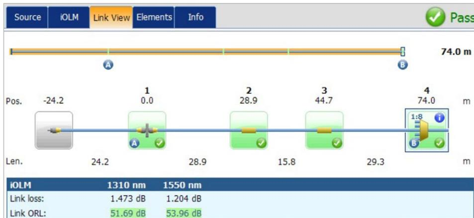
그림 3. 테스트 통과 - 라스트 마일 손실 및 ORL이 사양 범위 내입니다. 스플리터가 존재하고 예상 비율과 일치하는 것을 확인하고, 피더에 대한 연속성을 확인합니다. 라스트 마일 설치를 보증합니다.
