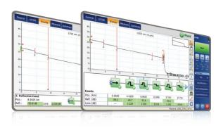
Diese verbesserte Ausführung ermöglicht dem Techniker, flexibel, sowohl die OTDR-Kurve als auch deren lineare Ansicht anzuzeigen, ohne die Messung an der Glasfaser wiederholen zu müssen.
