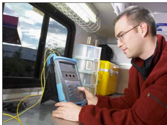
Gli OTDR a gamma lunga visualizzano tracce ad alta velocità in appena 10 secondi.
