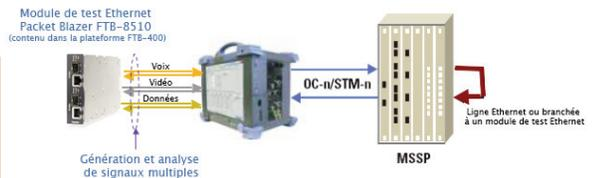
La combinaison des fonctions de test de multiples canaux Ethernet du FTB-8510B et des interfaces Ethernet intégrées aux modules FTB-8120NG/8130NG constitue une solution très puissante pour les tests de multiples services SONET/SDH.
