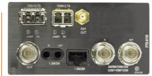
Module de test SONET/SDH et OTN FTB-8130.
