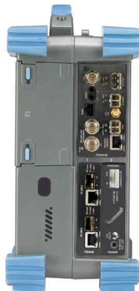
FTB-8510B Packet Blazer 以太网测试模块还与 FTB-400 通用测试系统和 FTB-500 平台相兼容。FTB-400 中所示为 FTB-8510G Packet Blazer 万兆以太网测试模块和 FTB-8130 Transport Blazer 下一代 SONET/SDH 测试模块。
