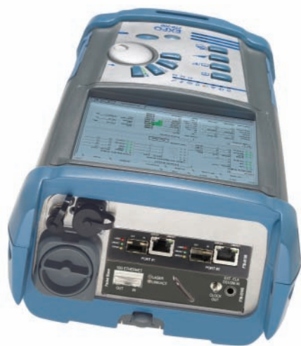
FTB-8510G Packet Blazer 万兆以太网测试模块也可以内置于 FTB-200 紧凑型平台中。平台中还显示了 FTB-8510B 以太网测试模块。
