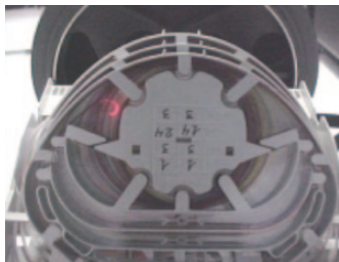
图 2-7. 使用 VFL 检测宏弯
