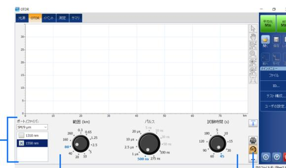
1 テストの波長を選択します。OTDR モデルによっては、ポートも選択できます。
