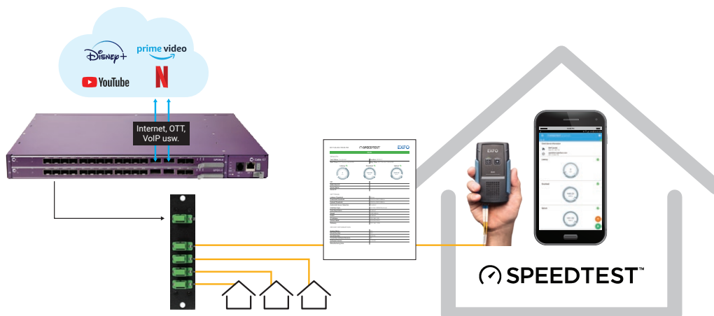
Abbildung 3. Speedtest über GPON oder XGS-PON
