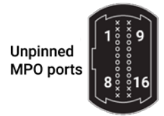
Figure 16. Configuration des ports MPO-24 avec 16
