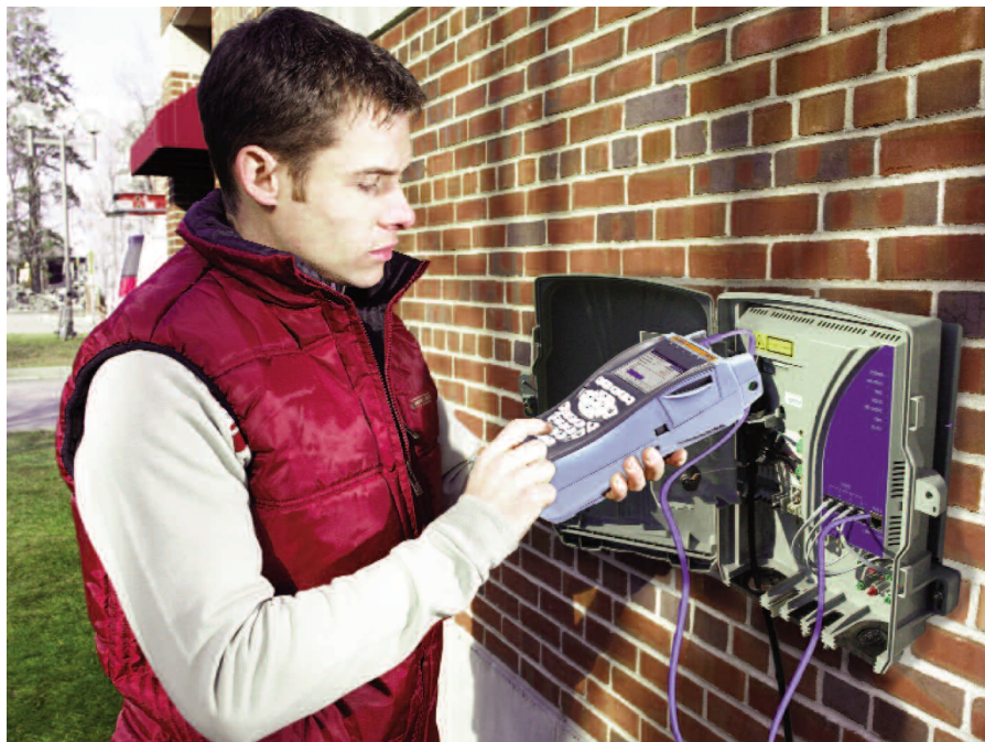
在 ONT 的以太网端口上测试 IPTV。
