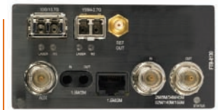
带有 SONET/SDH 和 OTN 测试功能的 FTB-8130 模块。
