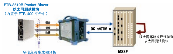
将 FTB-8510B 的以太网多数据流功能和 FTB-8120NG/8130NG 嵌入式以太网接口相结合, 为测试 SONET/SDH 网络上的多项服务创建功能强大的解决方案。
