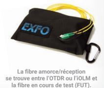
La fibre amorce/réception se trouve entre l'OTDR ou l'IOLM et la fibre en cours de test (FUT).
