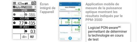
● Utiliser un mesureur de puissance optique (OPM) ou un microvérificateur de puissance (MPC) pour vérifier si les valeurs de puissance absolue sont conformes aux prévisions.
