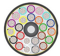
Exemple d'un câble à 3 456 fibres.
