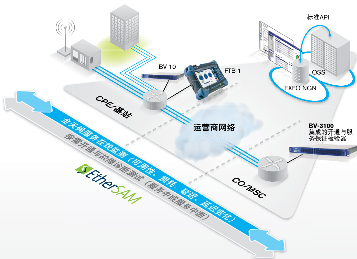
图1: BV-3100是EXFO的Ethernet One解决方案的组成部分，用于端到端以太网测试和监测。
