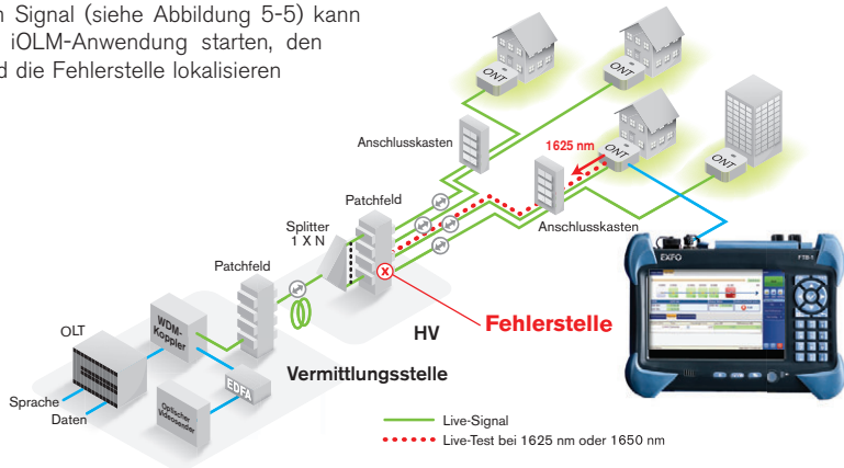
Abbildung 5-6: Live-Tests mit einem iOLM
