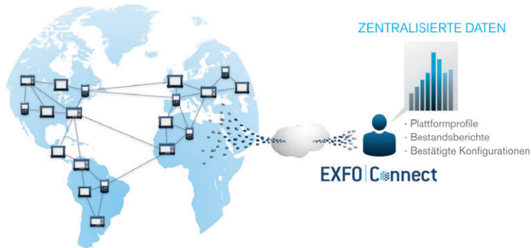
Abbildung 8-7: Funktionsprinzip des TEM-Testgerätemanagers von EXFO Connect
