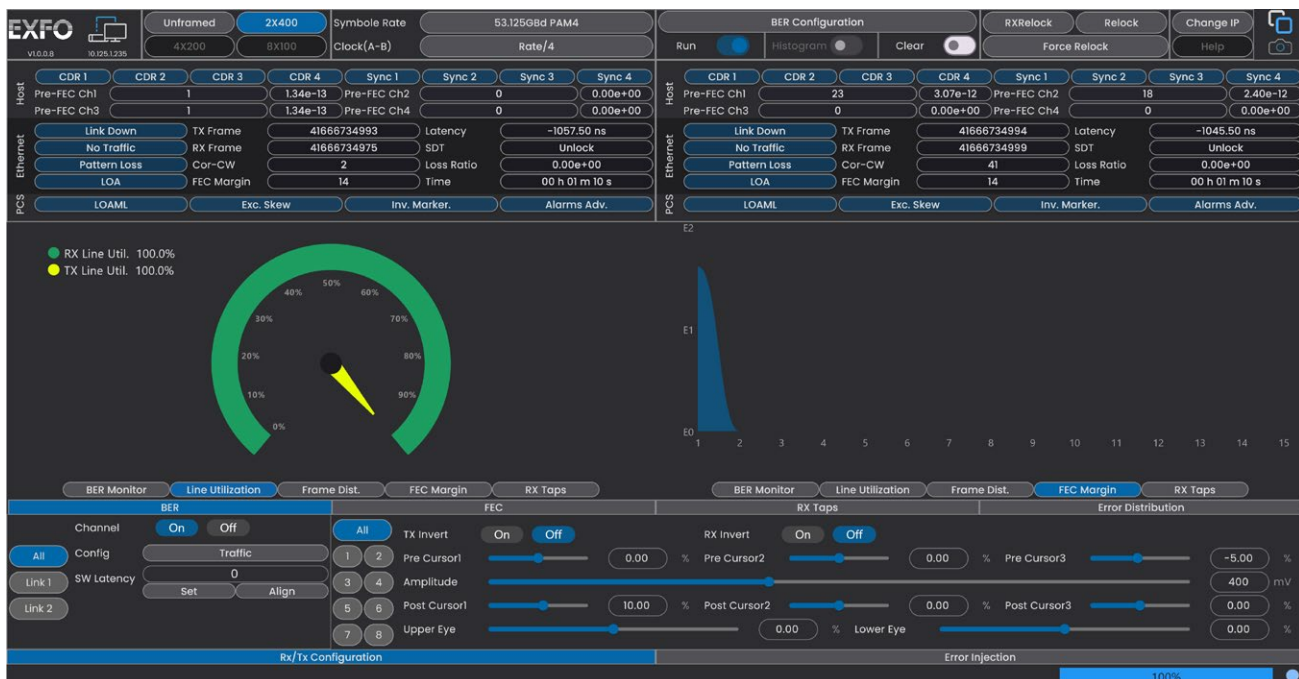
Figure 4. Test du BER pré-FEC, de la distribution des erreurs de symbole et de la marge FEC.
