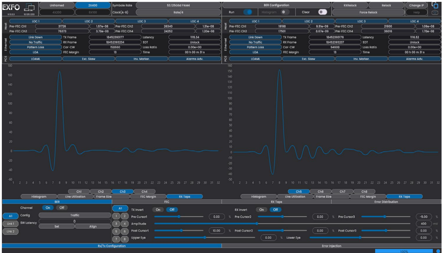
图3: 检测ISI和远端反射。
