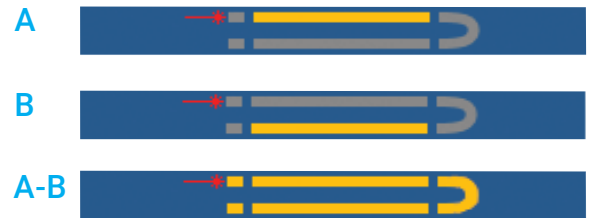
El uso del método de prueba de bucle de retorno y la opción iLOOP en iOLM le permite probar dos fibras a la vez. Vea solo el enlace A, el enlace B o el enlace A-B, incluido el bucle.
