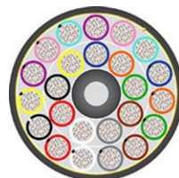
Esempio di cavo a 3456 fibre.
