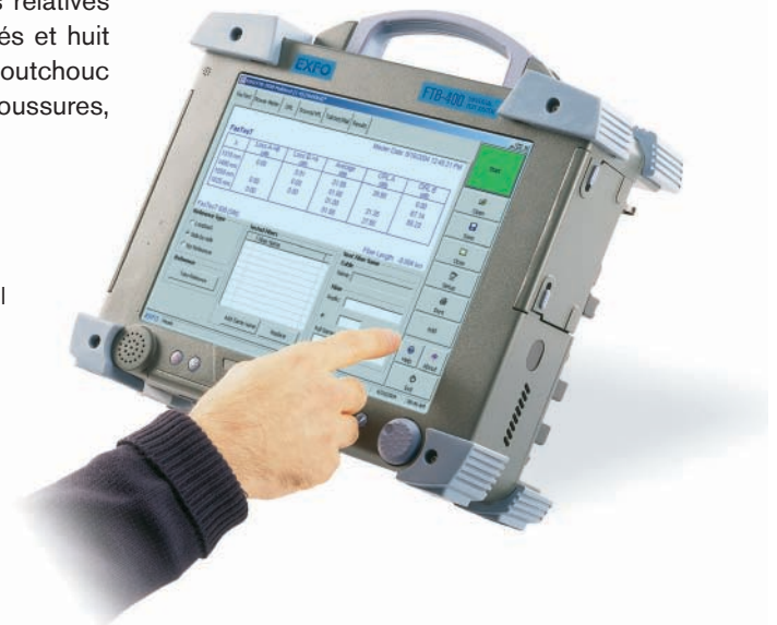
Parmi les nombreux composants du FTB-400 figure un écran tactile très efficace.
