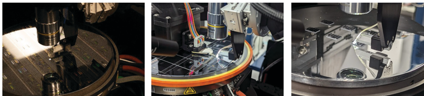
图3：使用一台OPAL-EC在整个工艺链上重新测试相同的电路：从晶圆到切割后晶圆上的单裸片，再到到适配板上的多个未填充裸片。在这里，使用了垂直耦合和DC探针。
