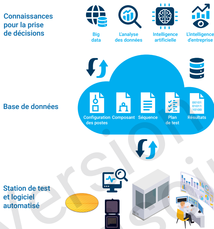
Figure 6. Les stations de test OPAL et le logiciel PILOT automatisent les essais PIC avec des fonctions puissantes et évolutives, en utilisant plusieurs applications liées à une base de données collaborative pour l'analyse avancée des données et l'intelligence artificielle.
