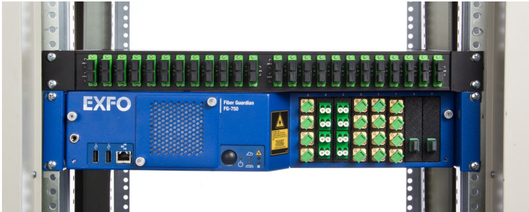
Généralement placés sur le dessus ou dans le même rack que l'unité Fiber Guardian, les ports de surveillance du kit TAM sont raccordés à l'arrière (SC, LC, MTP -12f ou MPO-8f) et connectés à l'avant de l'unité de test à distance.
