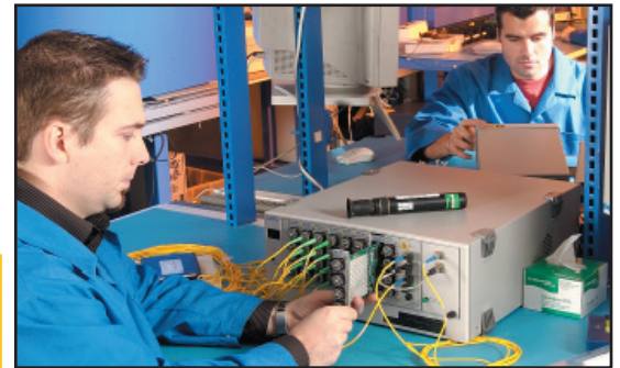
コンパクトな IQS-12008 システムを使用すると、生産現場で効率よくコンポーネントの特性を評価できます。
