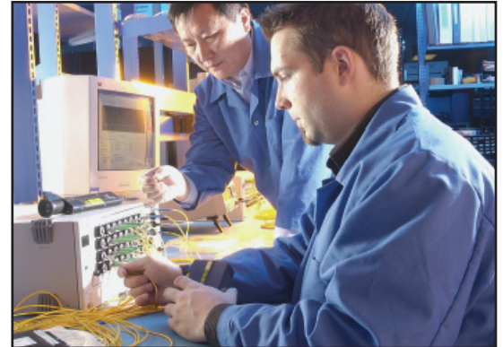
エキスフォのIQS-12008オールバンド・コンポーネント・アナライザは、おおよそ400nm波長範囲で、IL、ORL、PDLを測定します。
