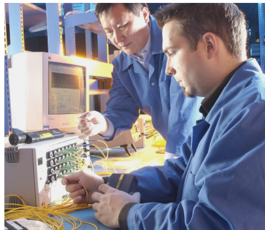
EXFO 的 IQS-12008 全波段器件分析仪可在近 400 nm 的波长范围上、最多以 32 个通道同时执行 IL、ORL 和 PDL 测量。
