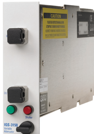
有无功率监控选项，IQS-3150 模块均仅占用 IQS-500 平台的一个插槽。
