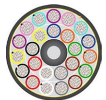
Beispiel für ein Kabel mit 3456 Fasern.
