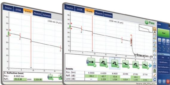
自2006年以来，我们的OTDR开始提供该线性视图，它以线性的方式为每个波长显示图标，从而简化OTDR曲线结果的读取。该视图将从传统的单脉冲曲线上获取的数据点转换为反光、不反光或分光器图标。采用通过/未通过阈值，可更容易地在链路上精准确定故障位置。
